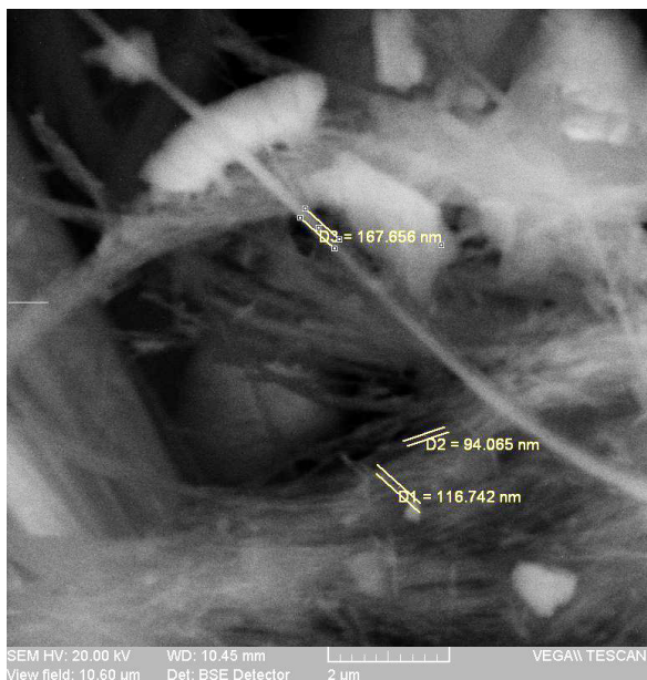
Рис. 2. Определение числовых измерений толщины хризотил-асбестовых волокон с помощью системы микроанализа INCA Energy
